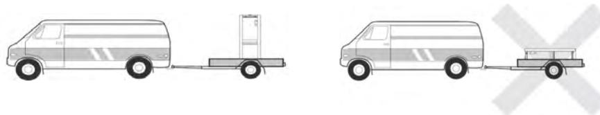
El equipo debe almacenarse y transportarse en todo momento en posición vertical sobre un palet, y en su embalaje original. En caso de guardarse o transportarse en posición horizontal, espere un mínimo de 24 horas antes de encenderlo.
