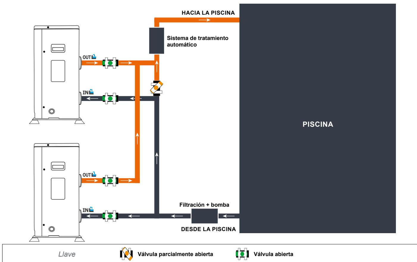
El filtro ubicado antes de la bomba de calor debe limpiarse regularmente para que el agua del sistema esté limpia y evitar de este modo problemas de funcionamiento derivados de la suciedad o el atascamiento del filtro.
